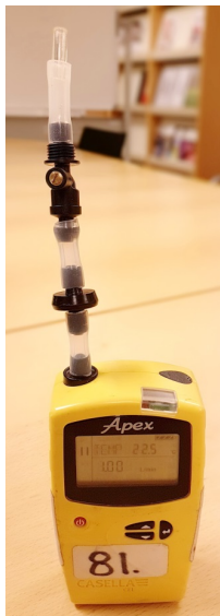
Figur 1. Pump med monterad flödesbegränsare.
